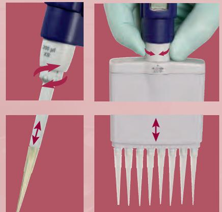
Ein reibungsloser sequentieller Spitzenabwurf bei allen Mehrkanalmodellen ist durch den leicht bogenförmigen Abwurfkopf gegeben.
